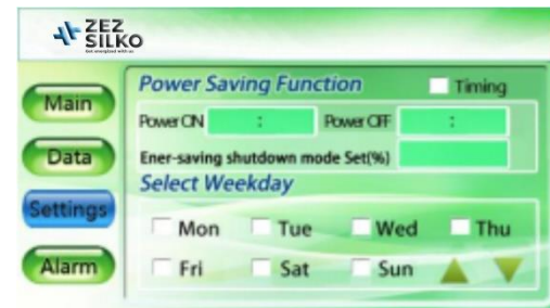
Obrázek 36: Funkce úspory energie
