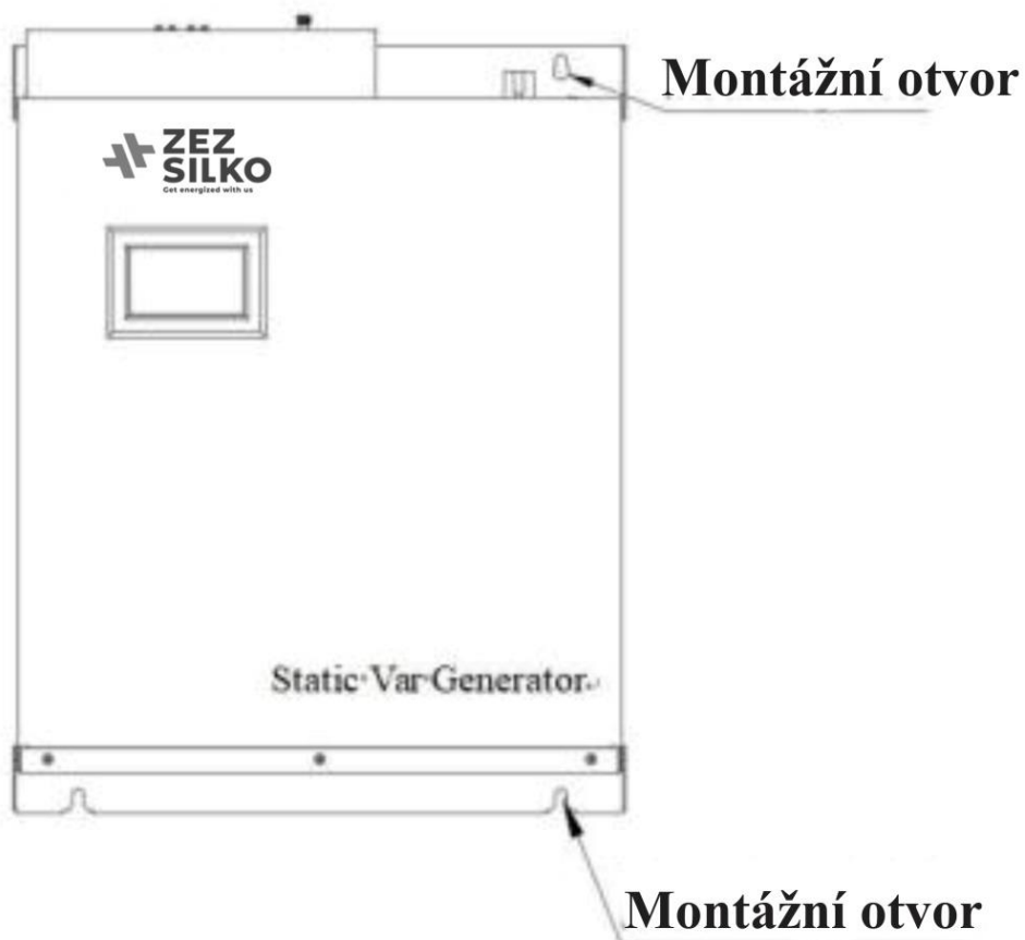
Obrázek 6: Náčrt pro montáž modulu SVG
