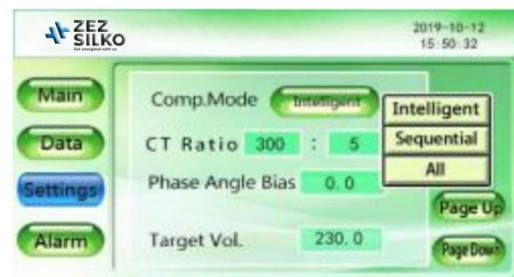
Obrázek 52: Kompenzační mód a poměr proudového transformátoru
